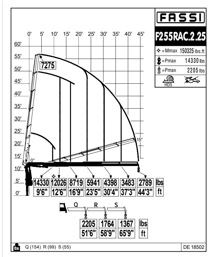
Crane belonging to the HC1 HD5 S2 class (if installed on truck) according to EN 12999:2011 - Grue appartenant à la classe HC1 HD5 S2 (s'il est installé sur le camion) selon la norme EN 12999: 2011 - Grúa que pertenezca a la clase HC1 HD5 S2 (si está instalado en el camión), de acuerdo con la norma EN 12999:2011
