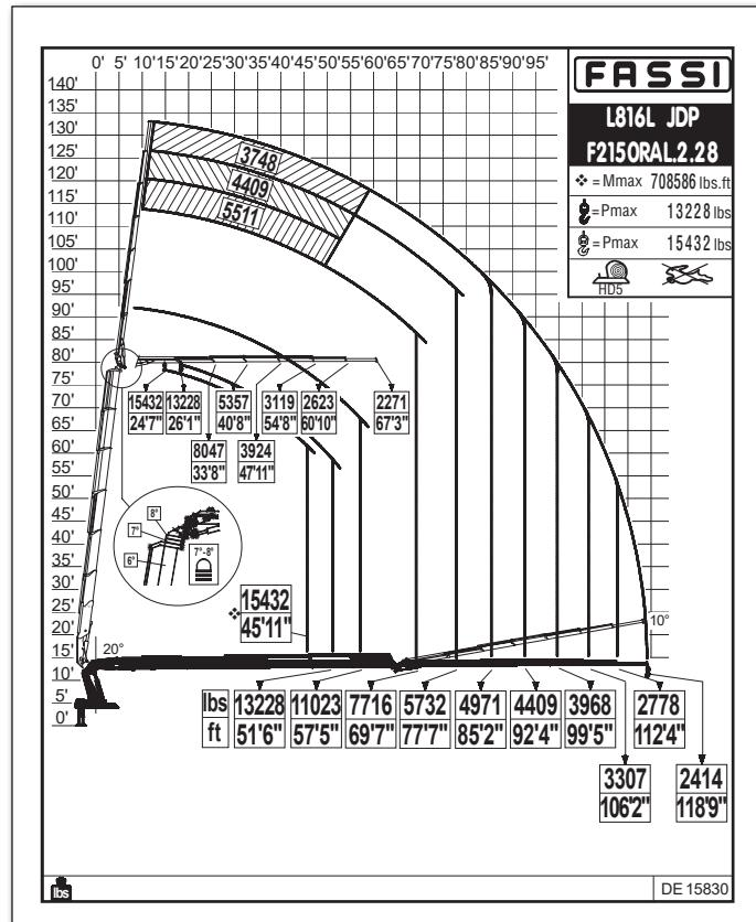
Crane belonging to the HC1 HD5 S2 class (if installed on truck) according to EN 12999:2011 - Grue appartenant à la classe HC1 HD5 S2 (s'il est installé sur le camion) selon la norme EN 12999: 2011 - Grúa que pertenece a la clase HC1 HD5 S2 (si está instalado en el camión), de acuerdo con la norma EN 12999:2011
