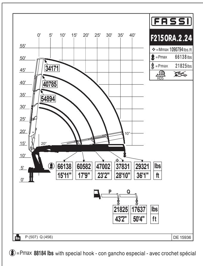
(\*) =Pmax 88184 lbs with special hook - con gancho especial - avec crochet spécial
